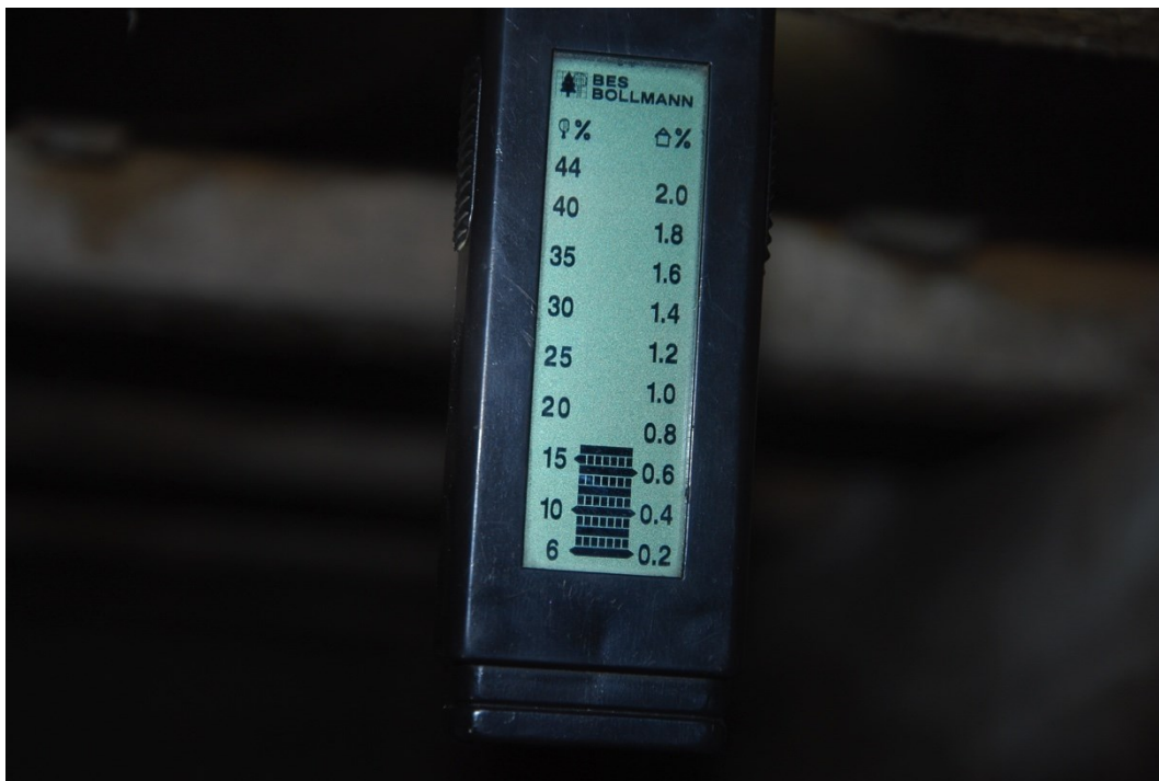
Foto nr. 7 Fugtindholdet i taglægter måles til 16 %, hvilket er normalt for årstiden
