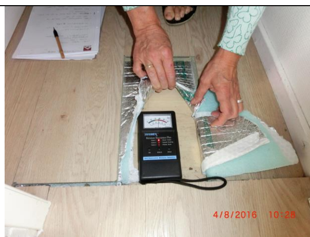
20 Fugtmåling gulv bygn. A
